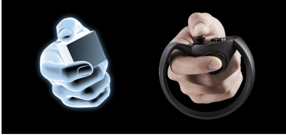
Abbildung 5: Controller bei der OCULUS Rift mit natürlicher Handhaltung (s. Oculus VR 2017)
